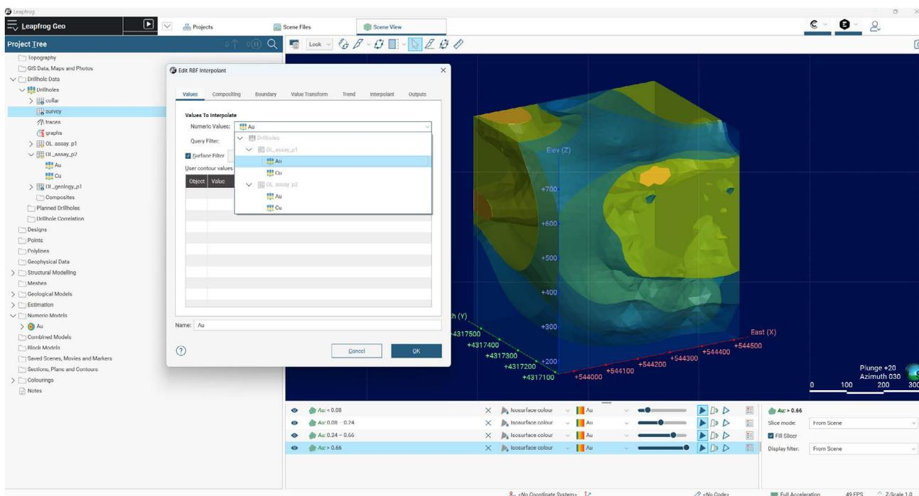
В Leapfrog 2024.1 реализована возможность изменять источник данных для числовых моделей после их создания. При помощи этого обновления вы сможете легко переключать ввод числовых моделей (интерполянт РБФ, интерполянт с несколькими доменами) без излишних усилий и затрат на повторное построение всей модели. Чаще всего это будет использоваться при копировании числовых моделей.
