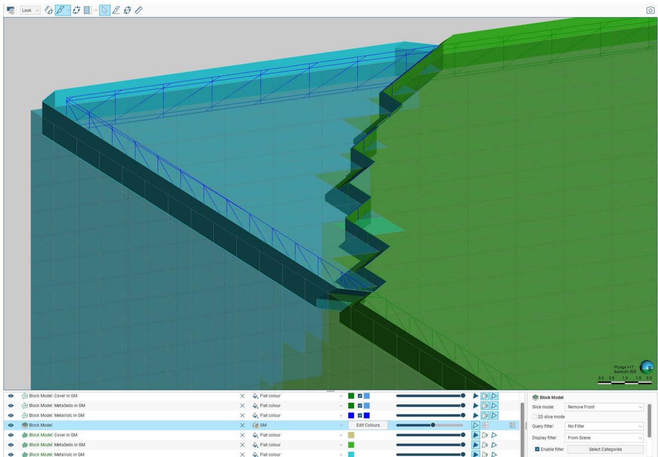
Обновлен и оптимизирован параметр Grid Surface (Поверхность сетки) на точечных и геофизических сетках, а также в обычных блочных моделях. В результате этого изменения сглаживается форма объема на границе.
