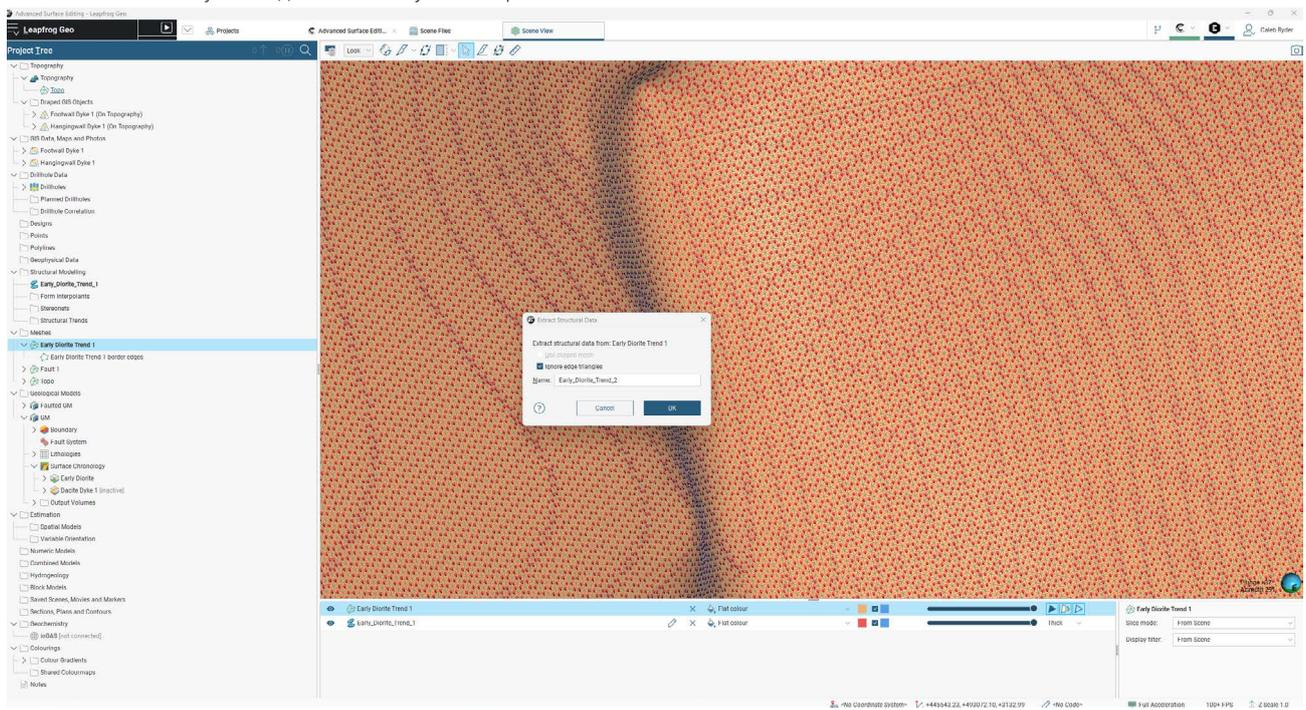
Новый рабочий процесс Extract Structural Data (Извлечь структурные данные) напрямую генерирует структурные измерения (угол падения и азимут) для каждого треугольника в каркасной сетке. Благодаря этому нет необходимости сначала извлекать вершины, а затем оценивать структурные данные (обратите внимание, что существующий объем функции Estimate Structural Data (Оценить структурные данные) полностью сохранен).
