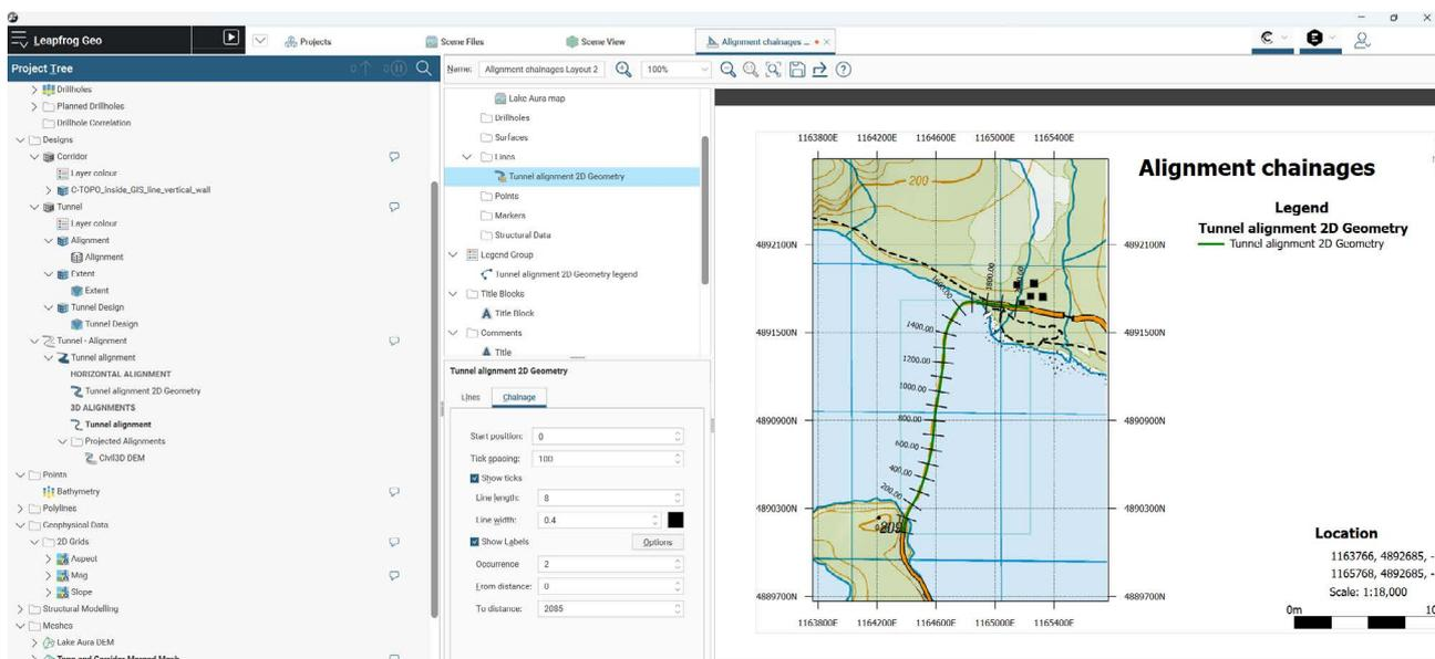
На видах в плане и/или разрезах теперь можно отображать разметку вдоль линейных объектов. Это улучшит понимание и обмен информацией об относительных положениях вдоль линейных объектов на плане, на разрезе и в трехмерном Рабочем окне.
