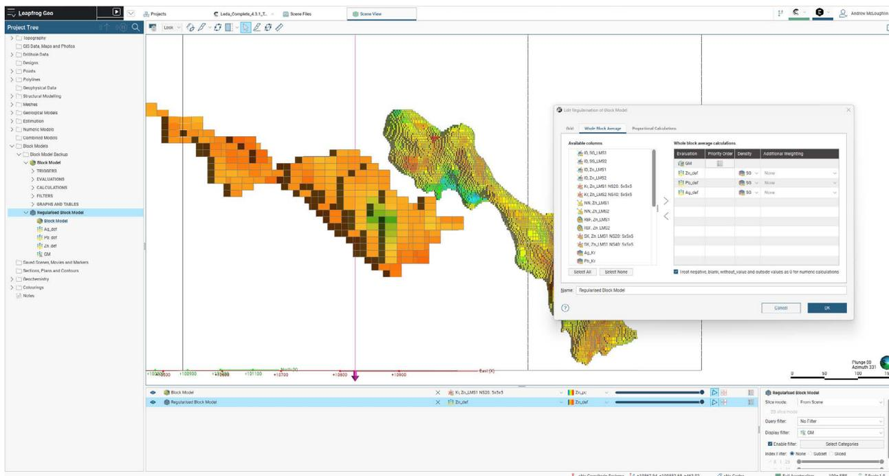
Регуляризация уменьшает размер блочной модели за счет объединения блоков и часто используется при планировании горнодобывающих работ, где подробные блочные модели, по сути, представляют собой излишние накладные расходы на обработку, передачу и/или хранение данных, и в обязательном порядке требуются лишь для сравнения и составления отчетов по блочным моделям.
