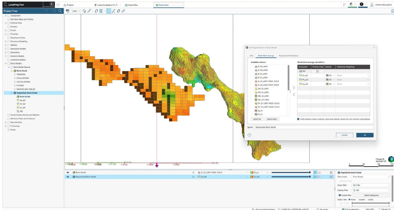
A regularização reduz o tamanho de modelos de blocos ao combinar blocos e é usada com frequência em planos de lavra quando modelos de blocos detalhados são um custo indireto desnecessário para processar, transferir e/ou armazenar, mas são essenciais para comparar e gerar relatórios com base neles.
