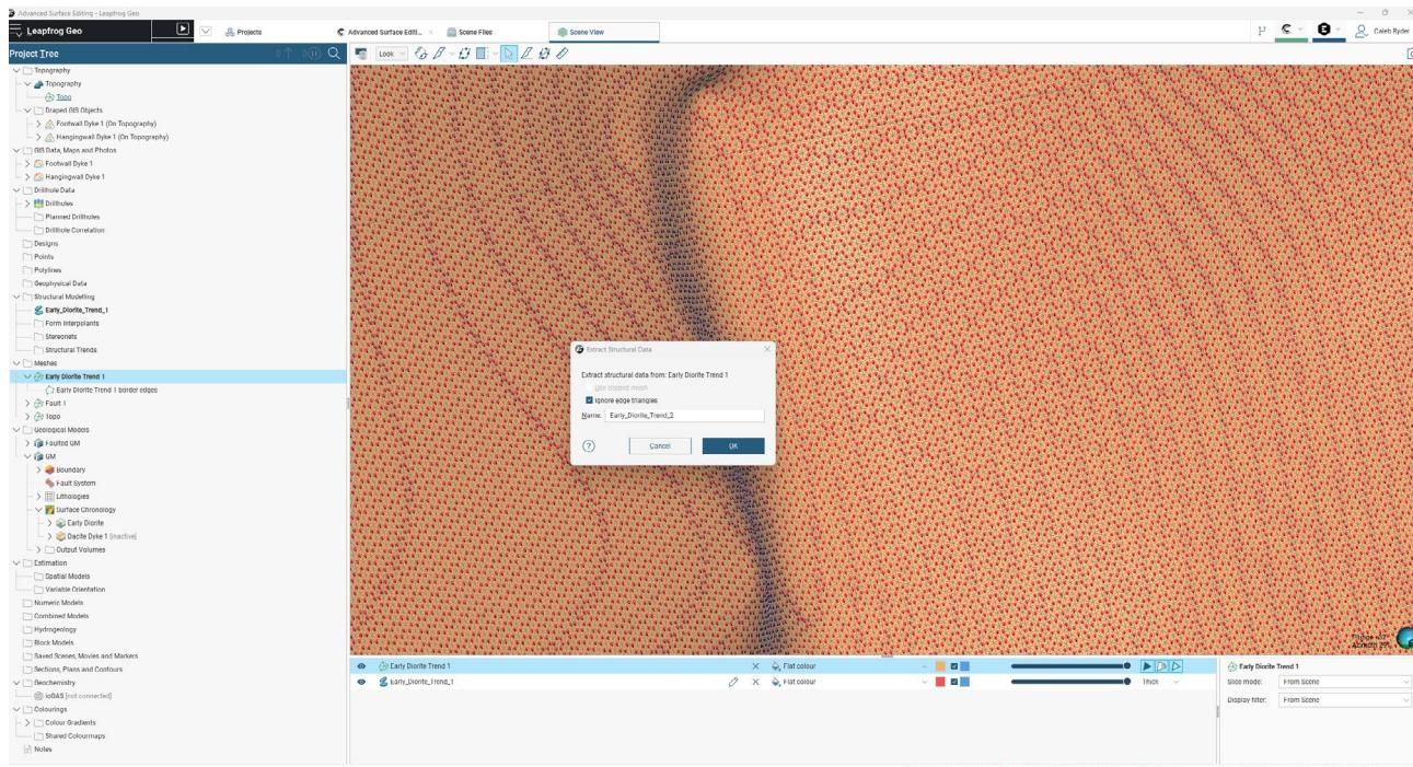
Um novo fluxo de trabalho "Extract Structural Data" gera uma medida estrutural (mergulho e azimute) para cada triângulo em uma mesh diretamente. Isso elimina a necessidade de primeiro extrair vértices e, em seguida, "Estimate Structural Data". Observe que a funcionalidade existente "Estimate Structural Data" foi mantida.
