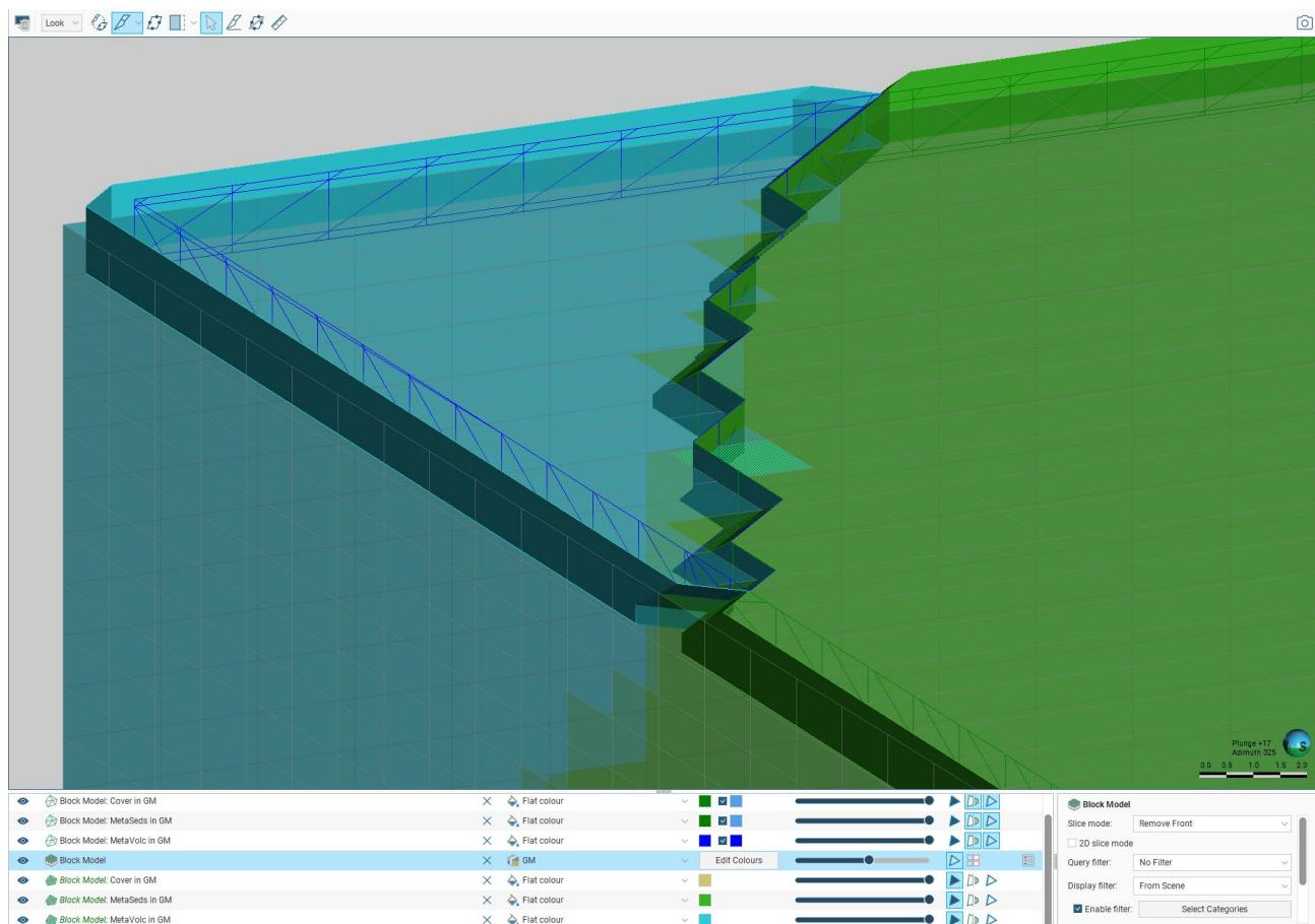
A opção Grid Surface em malhas de pontos, malhas geofísicas e modelos uniformes de blocos foi atualizada e otimizada. Consequentemente, a forma do volume no limite é suavizada.
