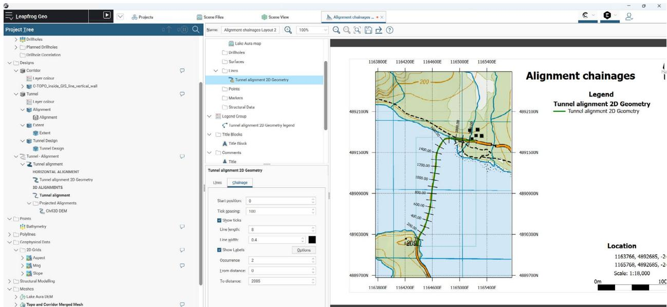
На видах в плане и/или разрезах теперь можно отображать разметку вдоль линейных объектов. Это улучшит понимание и обмен информацией об относительных положениях вдоль линейных объектов на плане, на разрезе и в трехмерном Рабочем окне.
