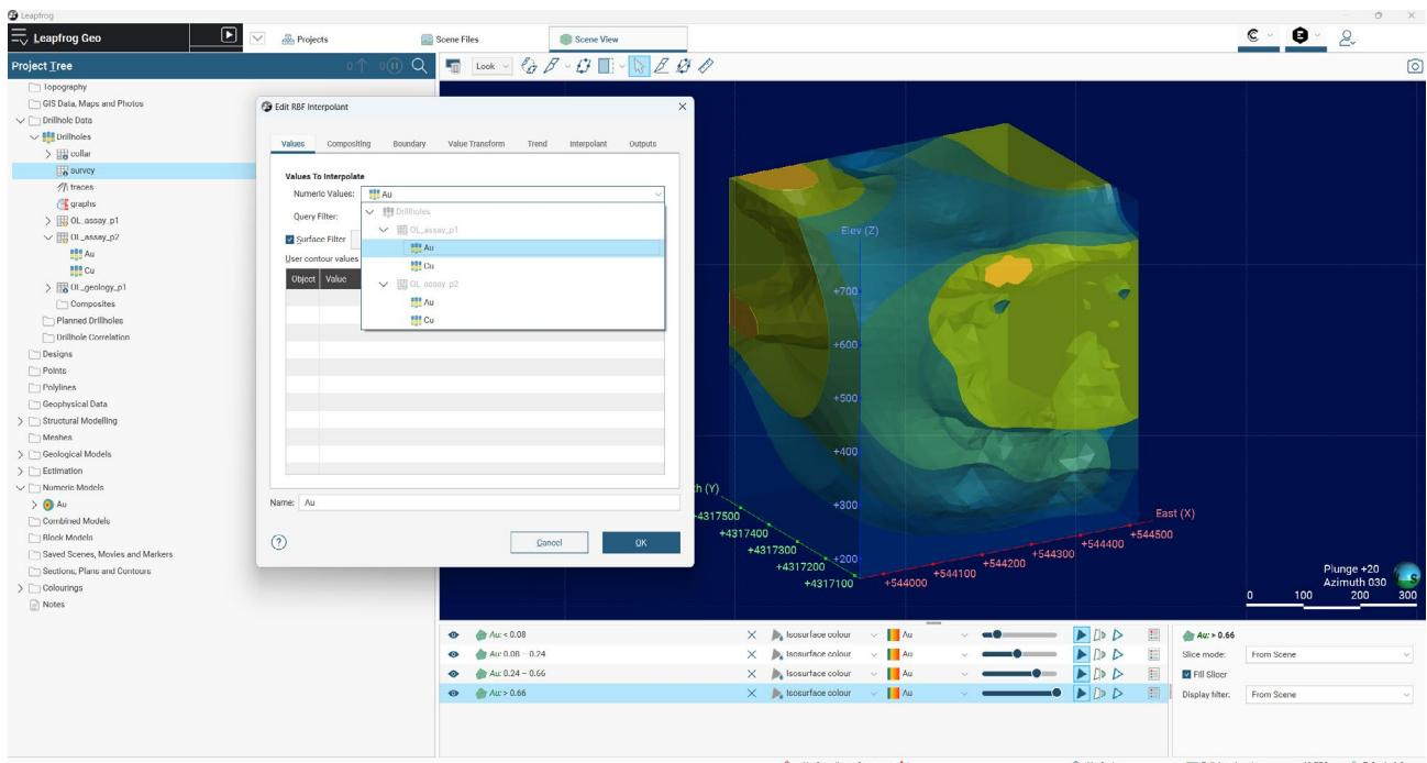
В Leapfrog 2024.1 реализована возможность изменять источник данных для числовых моделей после их создания. При помощи этого обновления вы сможете легко переключать ввод числовых моделей (интерполянт РБФ, интерполянт с несколькими доменами) без излишних усилий и затрат на повторное построение всей модели. Чаще всего это будет использоваться при копировании числовых моделей.
