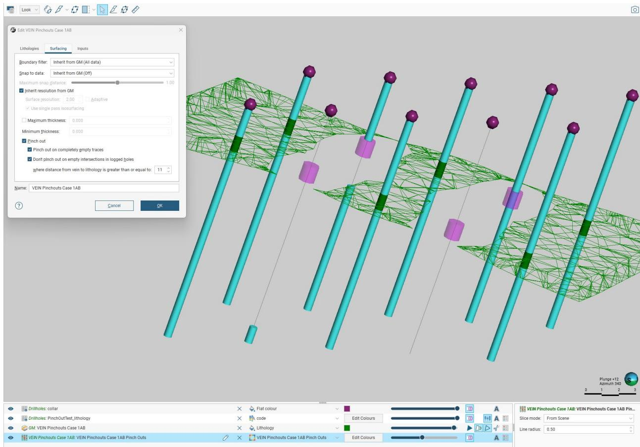
Небольшое, но важное обновление инструмента моделирования жил позволяет определять выклинивания на пустых пересечениях, которые появляются в скважинах, где каротаж выполнен другим способом. На вкладку Surfacing (Настройка поверхностей) диалогового окна редактирования добавлена опция, позволяющая управлять действием и моментом применения изменения к вашей стратегии моделирования. К существующим моделям жил никакие изменения применяться не будут.
